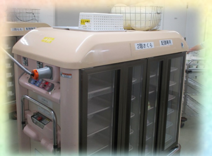
＜温冷配膳車＞ 温かい物は温かく 冷たいものは冷たく 提供しています
